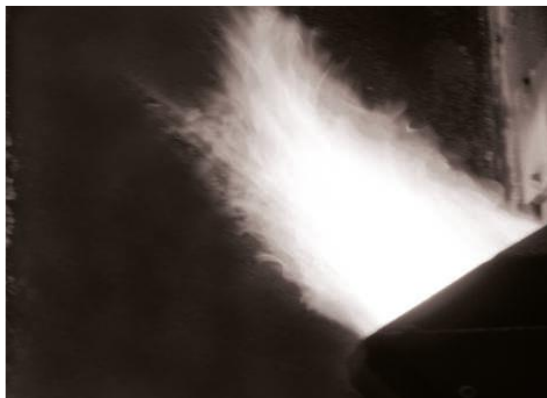
Jasny biały ogień wskazuje na to, że dopływ powietrza jest zbyt duży.
